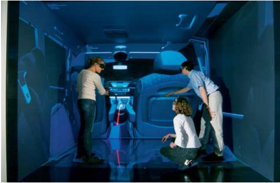
Рис. Б. 2. 33. Використання тривимірні системи візуалізації CAVE і Holobench для створення тривимірної голографічної моделі салону автомобіля. Середина Середина 2000-х рр.
