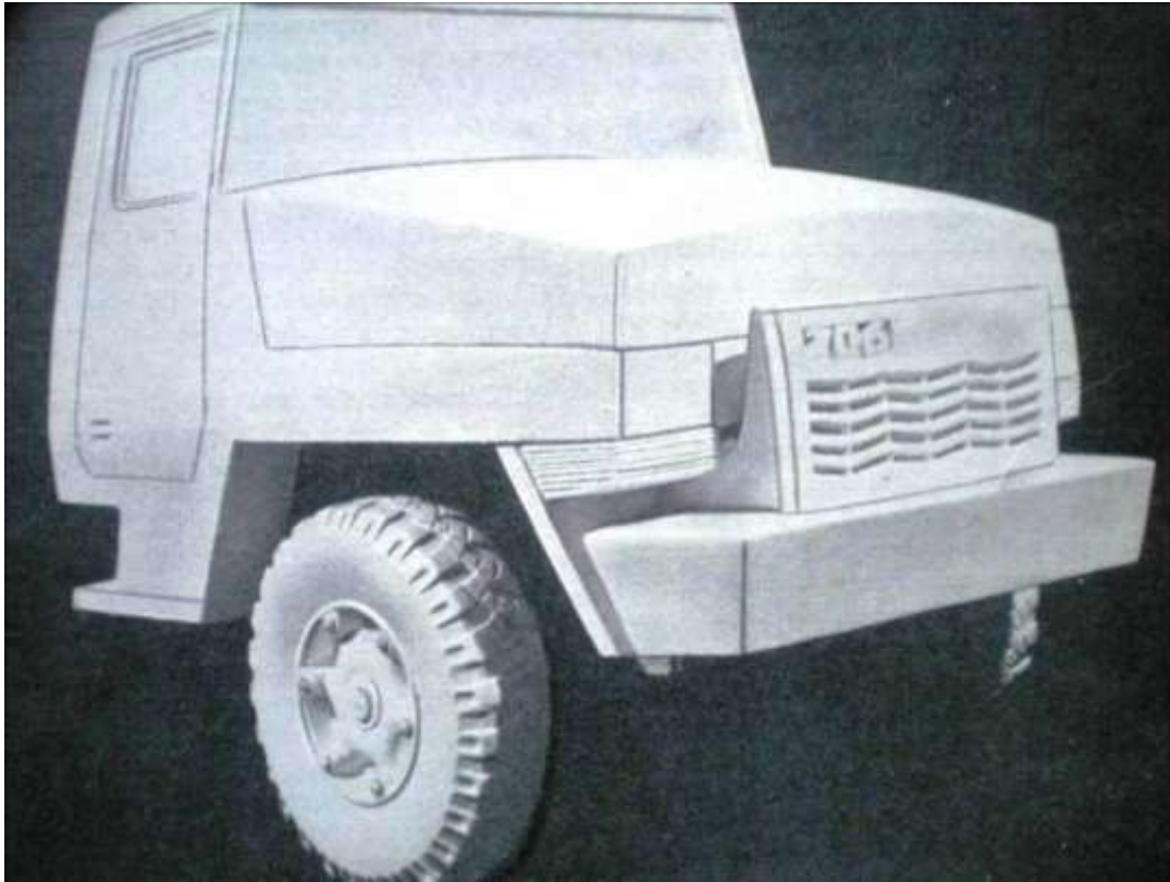
Рис. Б. 3. 3. Варіант зовнішньої форми кабіни вантажного автомобіля КРАЗ (київський філіал ВДНШТЕ). Кінець 60-х рр
