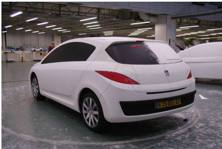
Рис. Б. 2. 40. Пінопластовий макет Peugeot 308 в масштабі 3/4 з намальованими дисками. Середина 2000-х рр.
