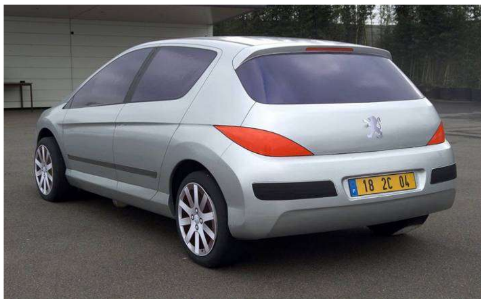
Рис. Б. 2. 41. Макет Peugeot 308 обклеєний спеціальною плівкою, що імітує фарбу. Середина 2000-х рр.
