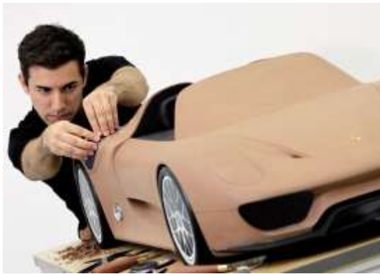
Рис. Б. 3. 34. Виконання масштабного макету Porsche 918 (а); виконання повномасштабного зіставного макету на станку з ЧПУ (б). 2010-і рр.
