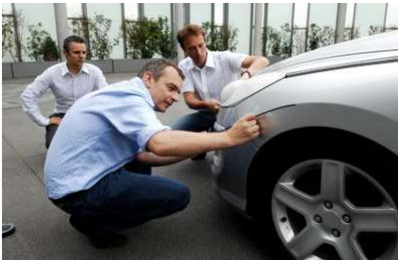
Рис. Б. 2. 43. Корегування обрисів автомобіля за допомогою спеціальної чорної стрічки – тейпа. Середина 2000-х рр.
