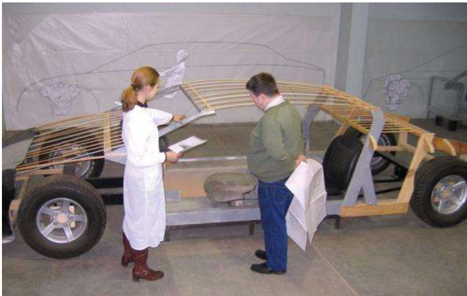
Рис. Б. 2. 22, 23. Компановочно-габаритні макети автомобіля «Вервольф». 2000-ті рр.
