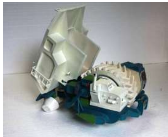
Рис. Б. 3. 6. Пошуковий макет самоскида з неklasичною схемою ходової частини (картон). Автор О. Луговський, кінець 1990-х рр.
