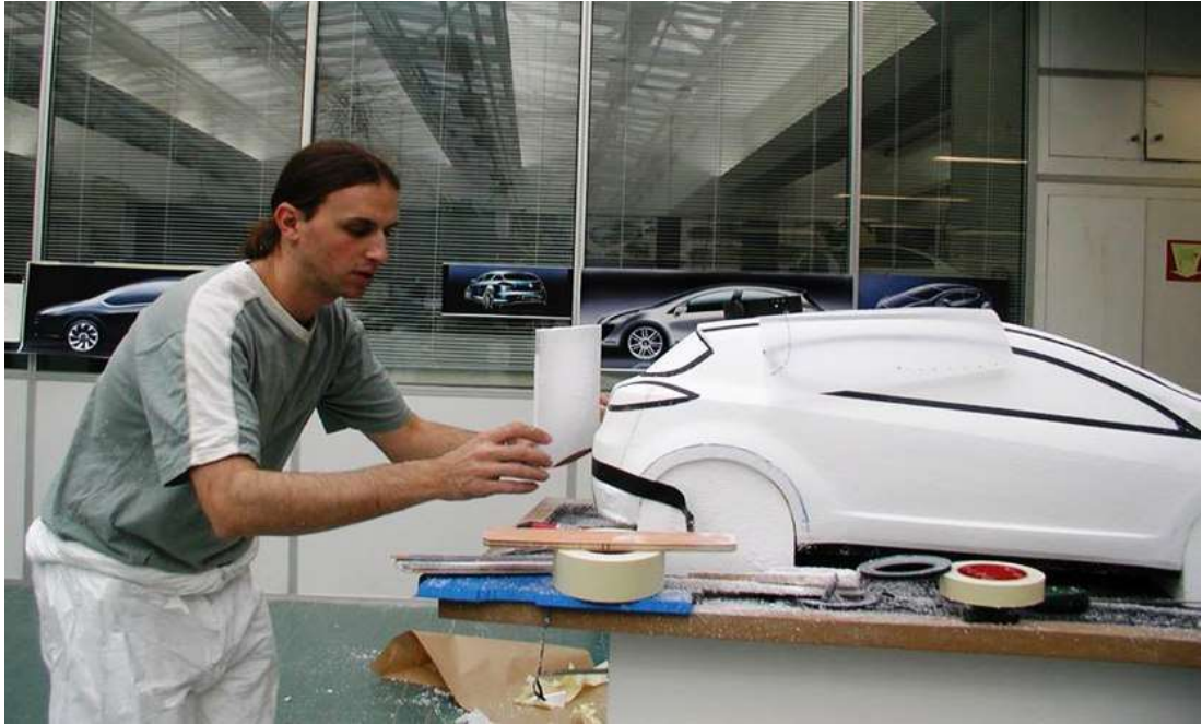
Рис. Б. 2. 38. Робота з виконаним по 3D-моделі пінопластовим макетом Peugeot 308. Середина 2000-х рр.
