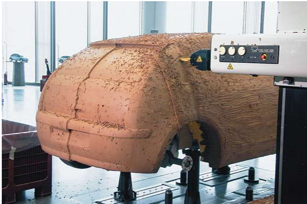
Рис. Б. 2. 29. З блоку пластиліну трикоординатний фрезерний верстат «вирізає» повномасштабний макет хетчбека Citroen C4. Середина 2000-х рр.
