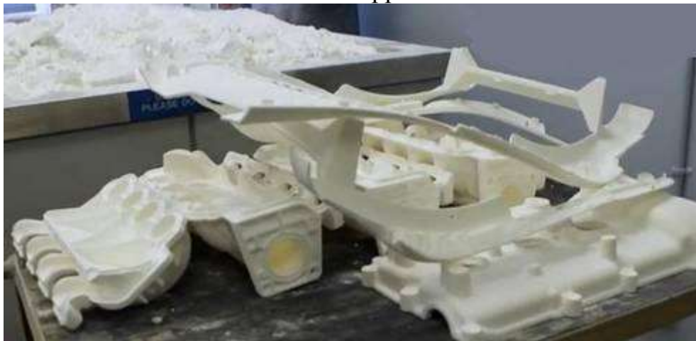
Рис. Б. 3. 12. Деталі двигуна Mustang виконані методом швидкого прототипування. 2010-і рр.
