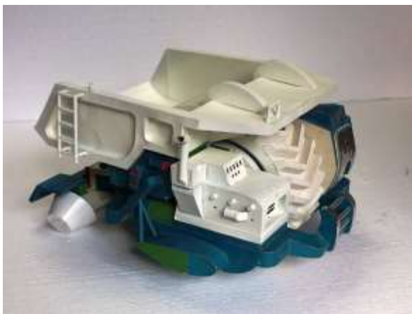
Рис. Б. 3. 6. Пошуковий макет самоскида з неklasичною схемою ходової частини (картон). Автор О. Луговський, кінець 1990-х рр.
