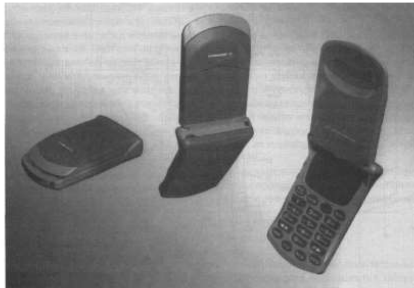
Рис. Б. 2. 12. Комп'ютерна візуалізація концепції StarTAC. Даний дизайн був розроблений за допомогою програмного забезпечення для промислового дизайну фірми Alias Research Inc. 1990-ті рр.
