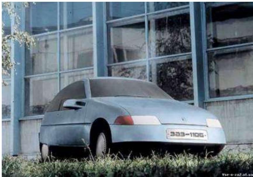
Рис. Б. 2. 19. Глиняний макет автомобіля ЗАЗ-1106 розробки 1990-х рр.
