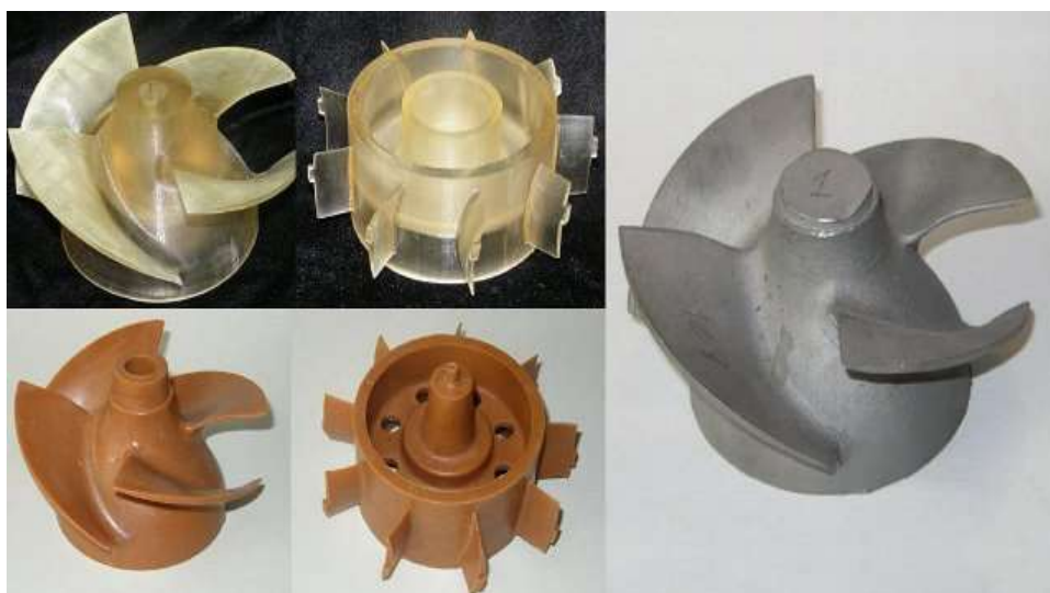
Рис. Б. 1. 25. Пластикові стереолітографічні моделі робочих коліс для водометних двигунів: воскові моделі та готовий металевий виливок.
