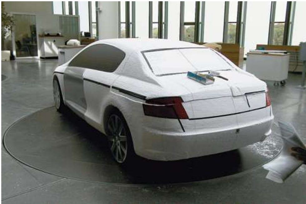
Рис. Б. 2. 32. Макет седана Peugeot 407 «складений» з «кубиків» пінопласту. Середина 2000-х рр.
