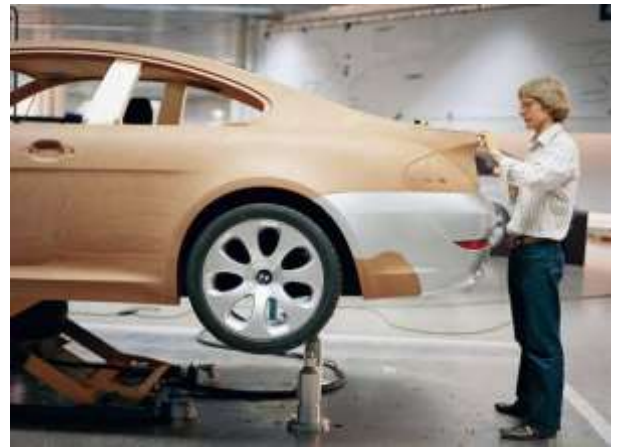
Рис. Б. 2. 58. Оновлена модель BMW 6 series (зліва). Процес роботи над глиняною моделлю (справа). 2000-і рр.
