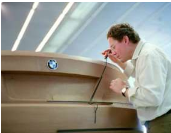
Рис. Б. 2. 59. Використання універсальних інструментів (зверху) та спеціальних (справа) при роботі з макетними матеріалами (пластлін, глина). BMW, 2000-ні рр.
