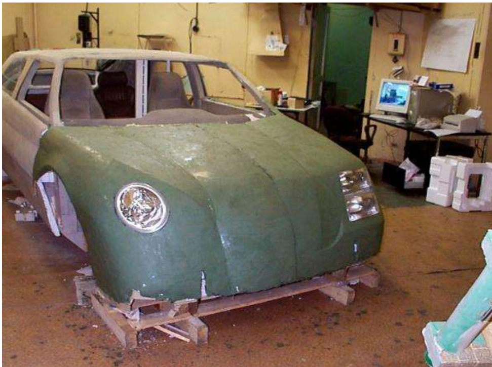
Рис. Б. 2. 27. Пошуковий макет в натуральну величину екстер'єру автомобіля «Вервольф». 2000-ті рр.
