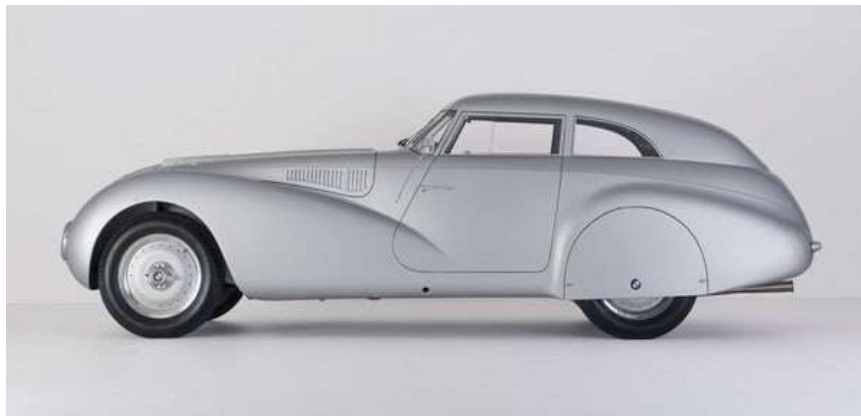
Рис. Б. 1. 23. Автомобіль з обтічною формою розробки Камма. 1938/1939 р.
