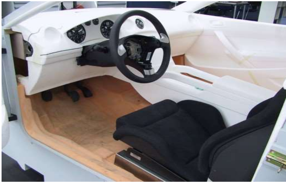
Рис. Б. 2. 50. Виконання макету інтер'єру Peugeot 308 з пінопласту. Середина 2000-х рр.
