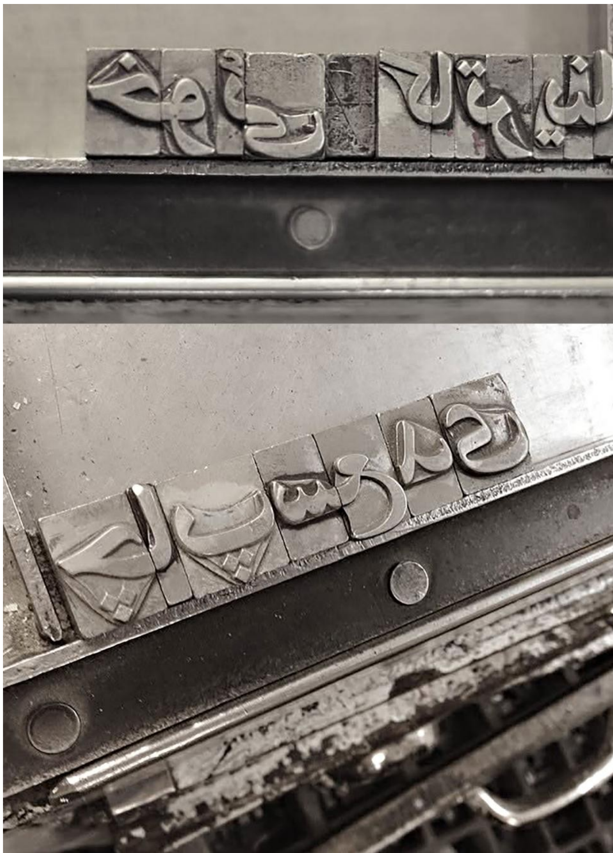
Іл. 3.82. Фотографія процесу складання арабських літер у сучасній лєтерпрєс-студії Grafolita (Esfahan, Iran)
