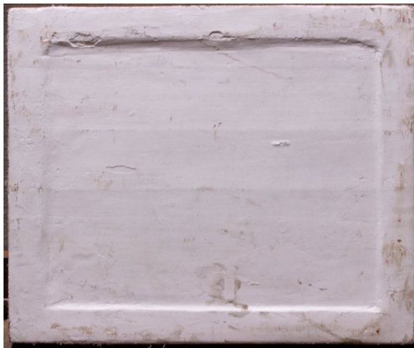
Іл.3. Зруйнований левкас через збільшення концентрації клею. (фото з архіву каф. РЕТМ ХДАДМ)
