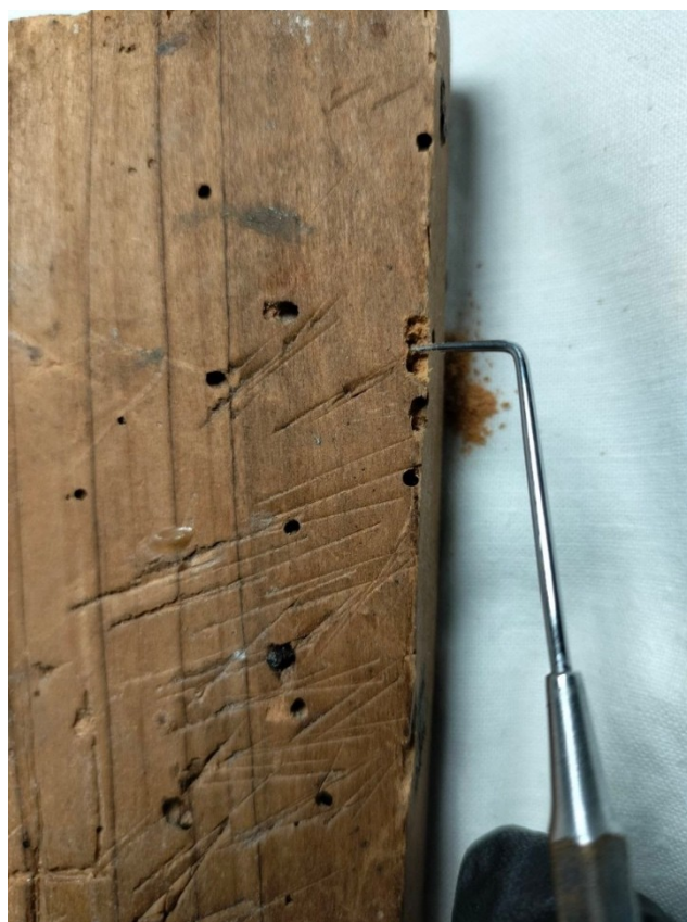
Іл.13. Процес видалення деструктованої деревини (фото Н. Антоненкової)
