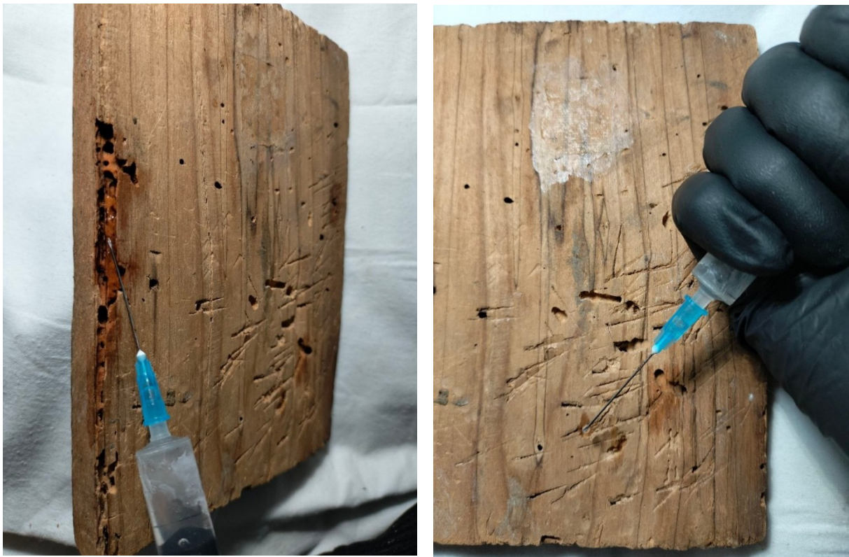
Іл.15. Процес укріплення деревини (фото Н. Антоненкової)
