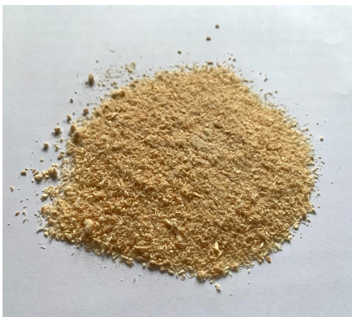
Іл.6. Дрібнодисперсна тирса для попаовнення втрат деревини
