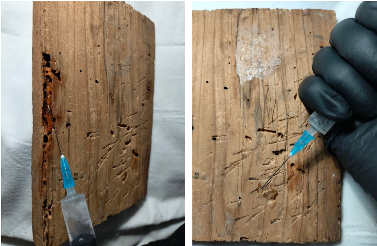
Іл.15. Процес укріплення деревини (фото Н. Антоненкової)
