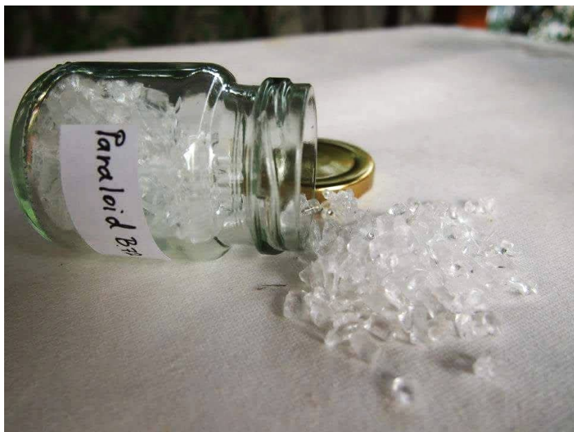
Іл.4. Paraloid B-72 у вигляді прозорих гранул
