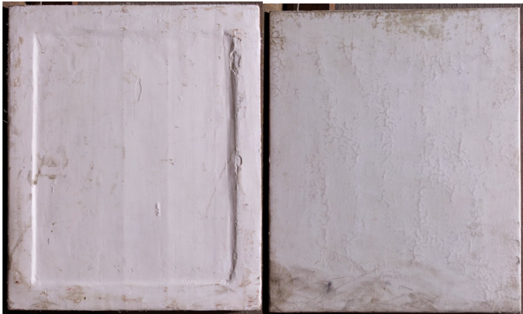
Іл. 7. Зруйнований левкас через збільшення концентрації клею
