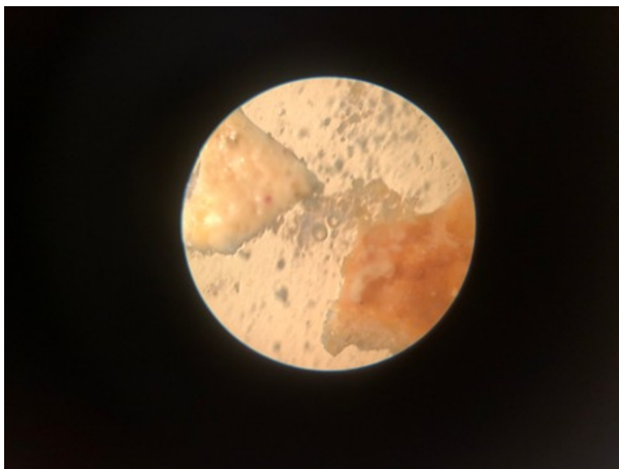
Іл.16. Утворення пухирців газу в результаті реакції зразку фарби тілесного кольору із хлоридною кислотою
