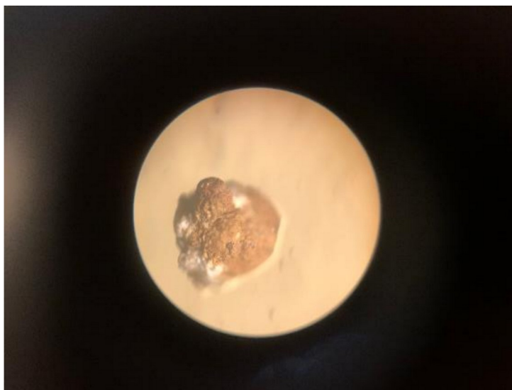
Іл.26. Зразок фарби після прожарювання змінив колір на коричневий.
