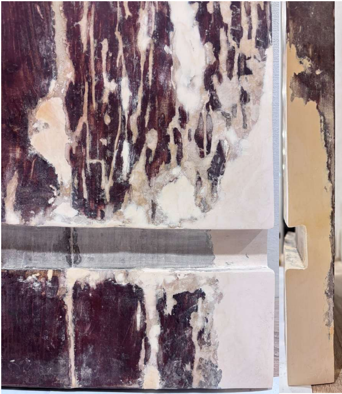
Іл. 71-72. Фрагменти фото тильної сторони в процесі поповнення втрат основи: проба № 6
