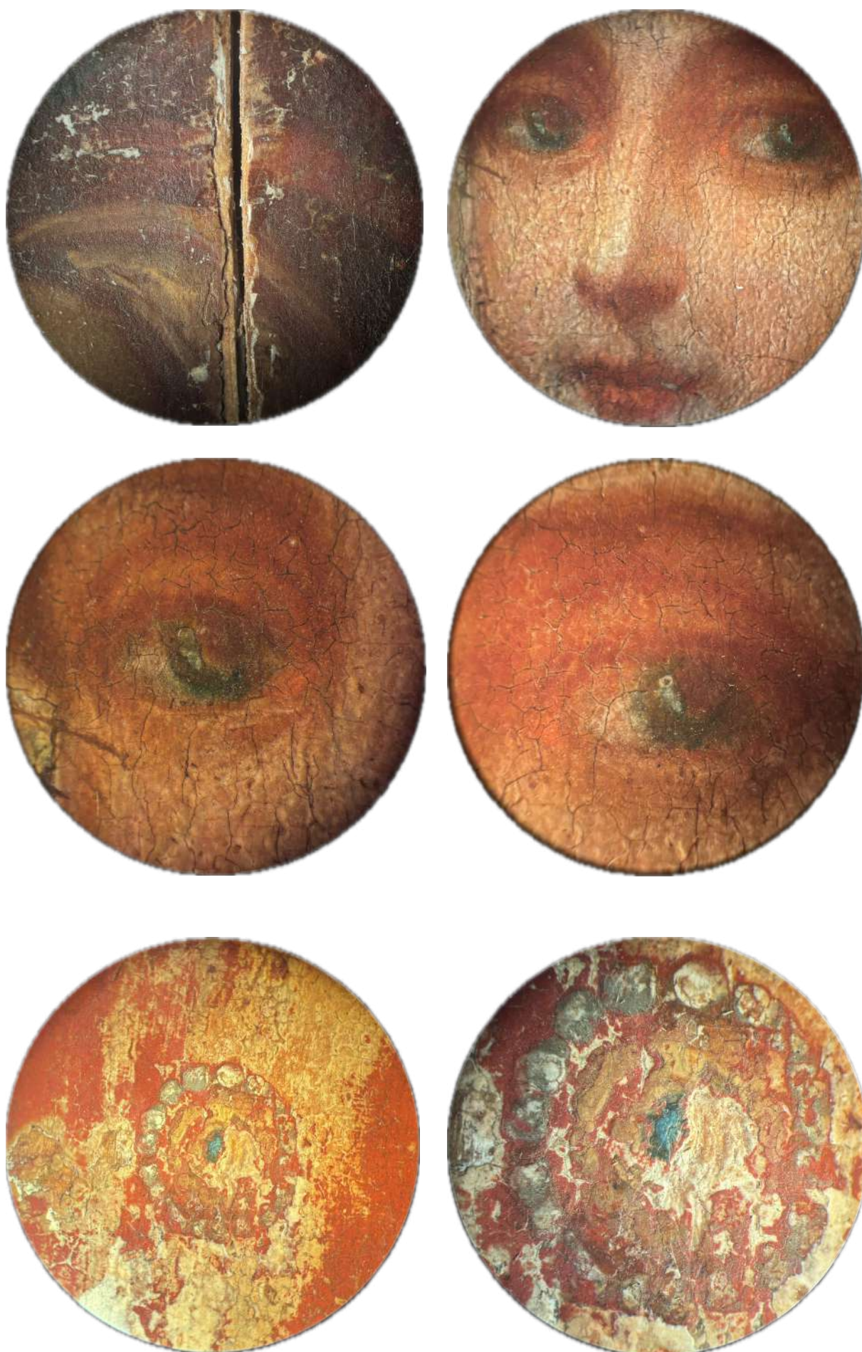
Іл. 43-56 . Фрагменти місць руйнування фарбового шару під мікроскопом
