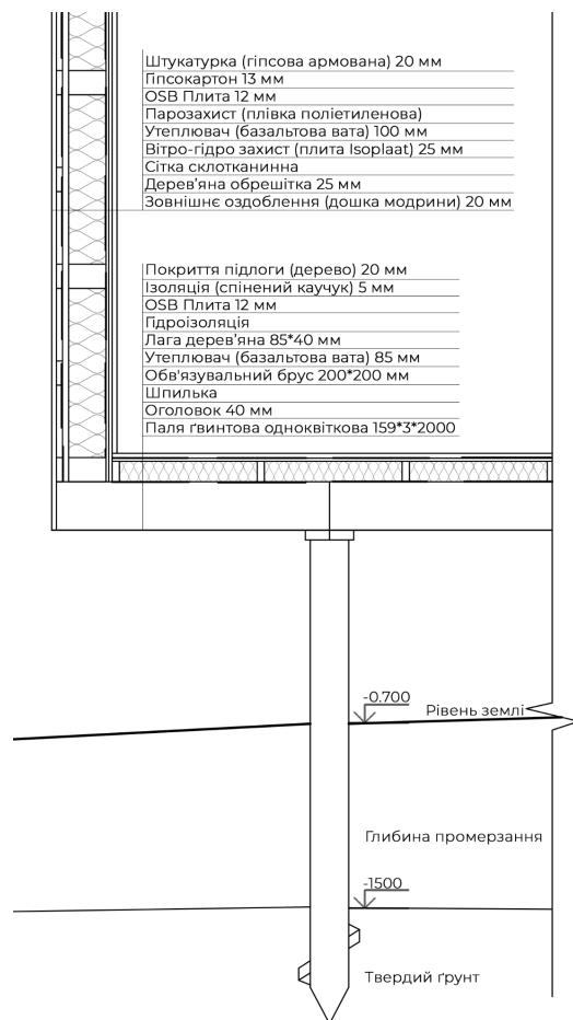
Рисунок 14. Конструктивний розріз фундаменту типології 1
